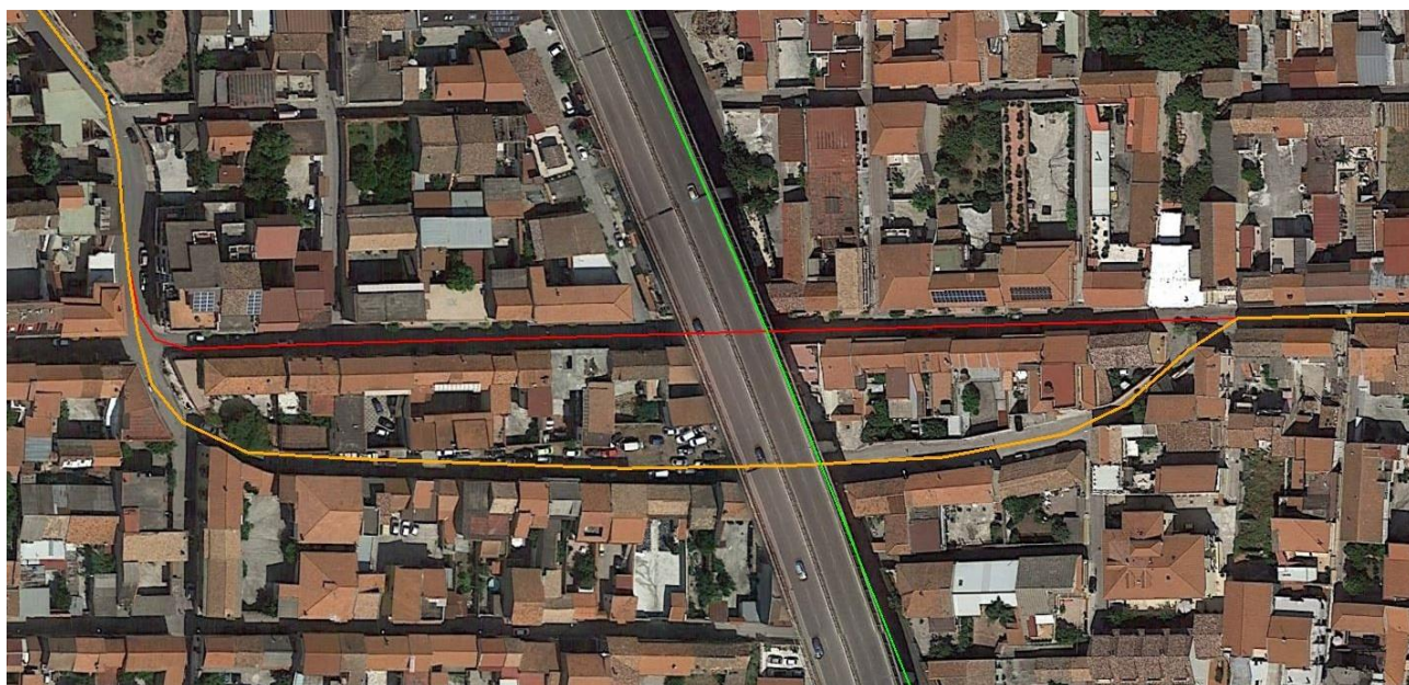
Figura 62 - Incrocio fra Linea 7 - Aversa-Albanova e ferrovia Alifana a Trentola-Ducenta. In una prima fase il tram procedeva dritto per via Roma (tracciato in rosso) e incrociava a raso la ferrovia Alifana (in verde). In una fase successiva fu costruito un sovrappasso ferroviario che correva per una deviazione (attuale via Bologna, tracciato in arancione).
