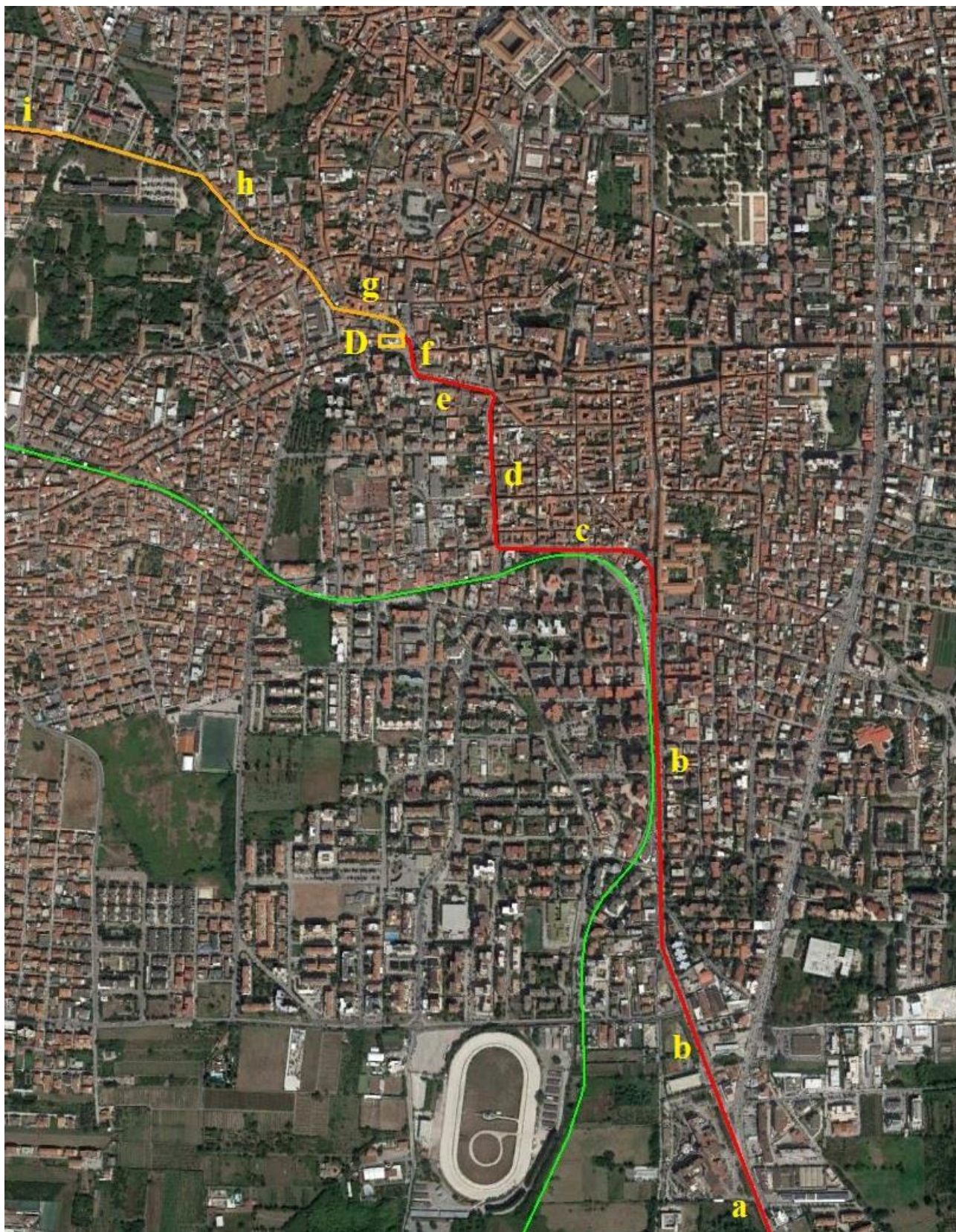
Figura 45 - Su immagine da Google, particolare della Linea 2 nell'abitato di Aversa. La linea verde riporta il tracciato della ferrovia Alifana e la linea arancione il tracciato della Linea 7 Aversa-Albanova; a = via Gramsci; b = via Vito di Jasi; c = via Belvedere; d = via Costantinopoli; e = via Magenta; f = piazza Francesco Crispi; g = via De Chiara; h = via Santa Lucia; i = via Roma; D = deposito-stazionamento.
