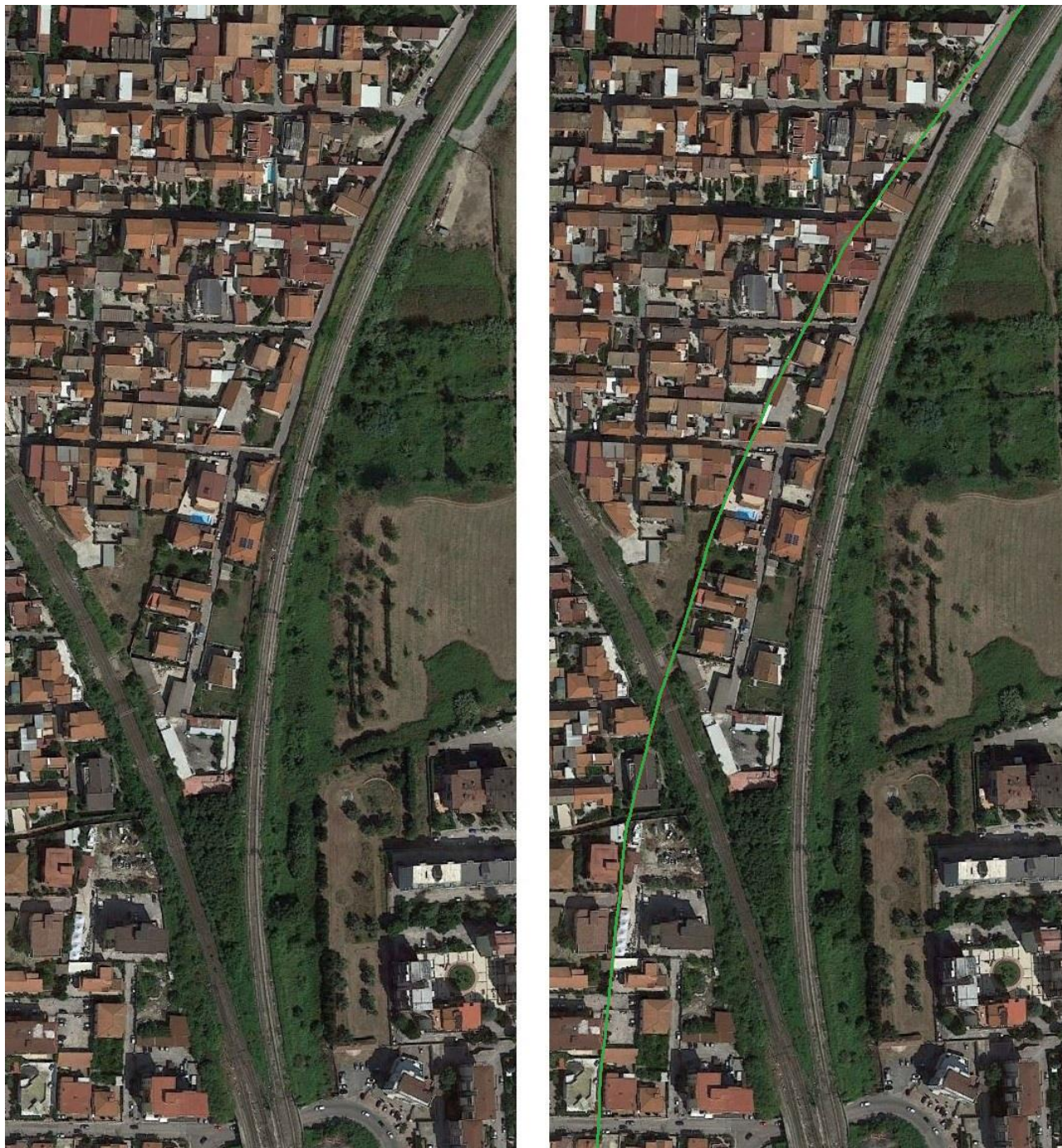
Figura 64 – Aversa, tracce del vecchio tracciato ferroviario (in verde), parte nord, chiaramente visibili in base ai confini fra le proprietà.
